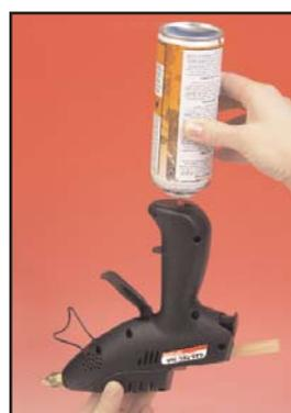
L'applicateur **GAS-TEC 300** se recharge tout simplement comme un briquet, à partir de recharges gaz, en vente partout, par exemple chez les buralistes. Son autonomie peut atteindre 1 heure, lorsqu'il est chargé à plein, selon l'utilisation. Il se recharge en quelques secondes (10 secondes quand il est entièrement vide). Une recharge doit permettre une vingtaine de remplissages.
