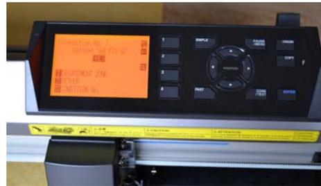
Le panneau de contrôle multilingue facilite le changement des réglages tels que vitesse et force de découpe.
