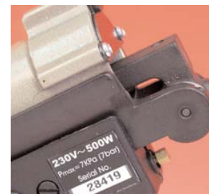
Bouton de réglage de la projection de colle par un gaucher ou un droitier
