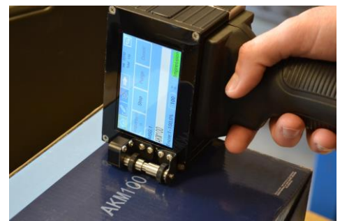
Impression en blanc avec le pistolet jet d'encre portable TI300 Mobil
